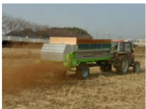
慣行の堆肥は人力もしくはマニユアスプレッダーによる機械散布
