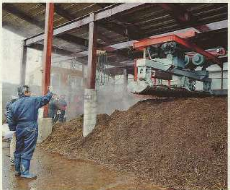
道東あさひ農協根室育成センターに道内で初めて導入された「E・L・S 堆肥化システム」
