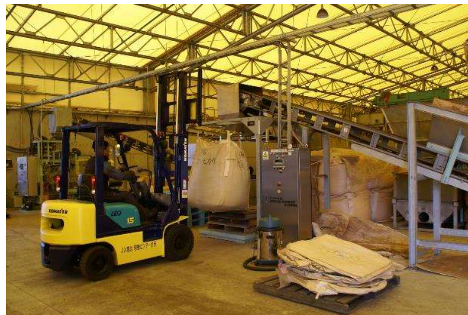
フレコンバックへの詰め込み
