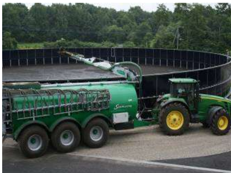
消化液散布機
